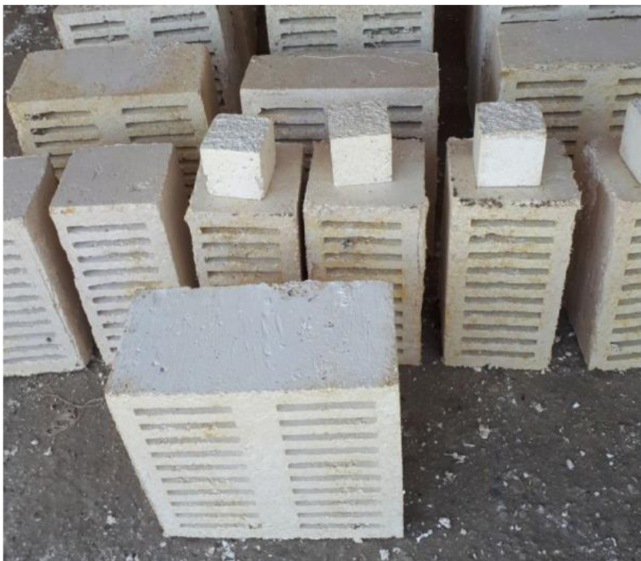
1-расм. Қурилиш гипси ва ёғоч қириндилари асосида олинган материалдан тайёрланган майда девор блоклари.
