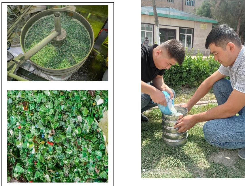
2-расм. Shisha siniqlari va chiqindilarini qayta ishlab shisha plitka chiqarish jarayoni
