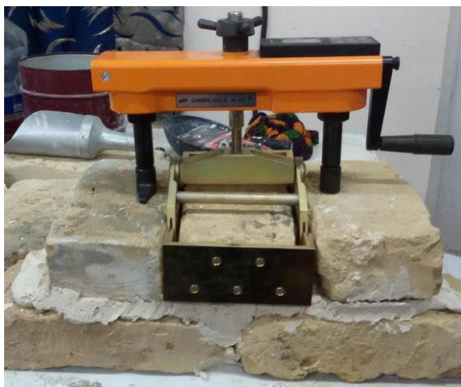
Рис 1. Прибор ОНИКС-ОС2, при помощи которого была изучена прочность при сцеплении модифицированного раствора на основе гипса в лаборатории
