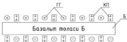
1-rasm. Sement gidrotatsiyasi natijasida yuzaga keladigan tuzilma tamini B Bazal't tolası: PK-Portlandsement kristallari, gidroalyuminat va gidrosul'faalyuminat kal'siy: GG-gidrosilikat geli zarrachalari.
