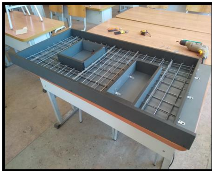
4-rasm. Yangi devor paneli maketini yasash va texnologik ketma-ketlikni ishlab chiqish
