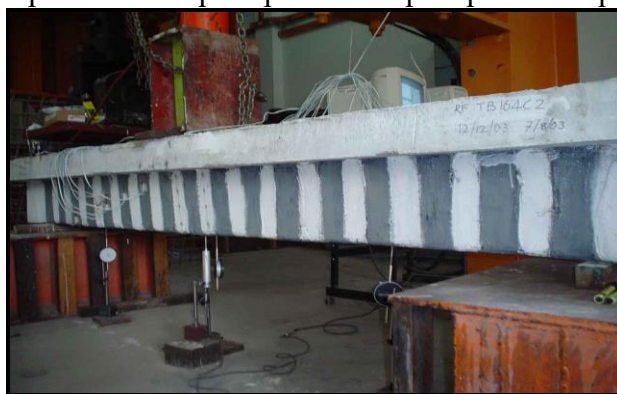
Рис. 5. Испытание тавровой балки при трехточечном изгибе ( a_v/d = 4.0 )
