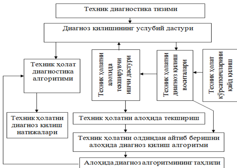
2 - расм. Кўприк иншоотларини такомиллаштирилган техник диагностика қилиш тизими
