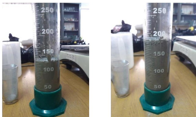
1-rasm. Alyumin kukinining aktivligini aniqlash jarayoni
