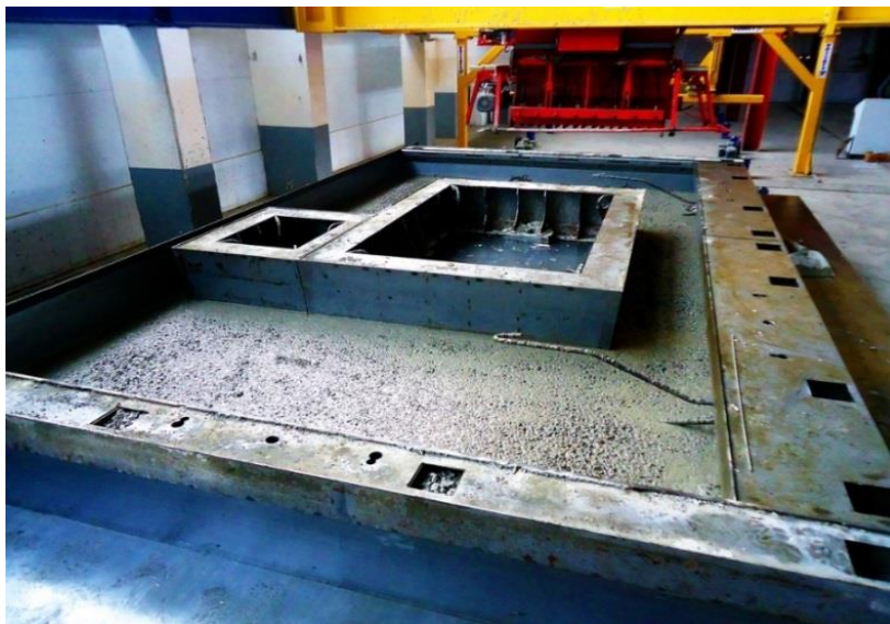
1-rasm. Devor panellari tayyorlanadigan eskirgan qolip texnologiyasi.
