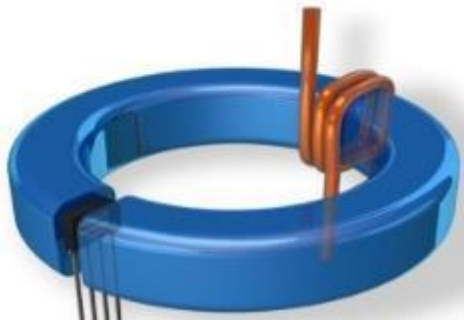
2- расм. Холл эффекти асосидаги магнит-гальваник ток ўзгартгичнинг тузилиш схемаси.
