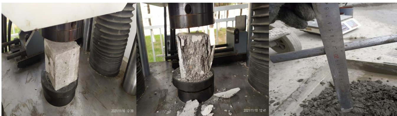
Расм 3. а) Оғир бетон таркибига (POLIMIX х2-222) суперпластификатори қушиб тайёрланган намуналар. б) конус чуқмаси.
